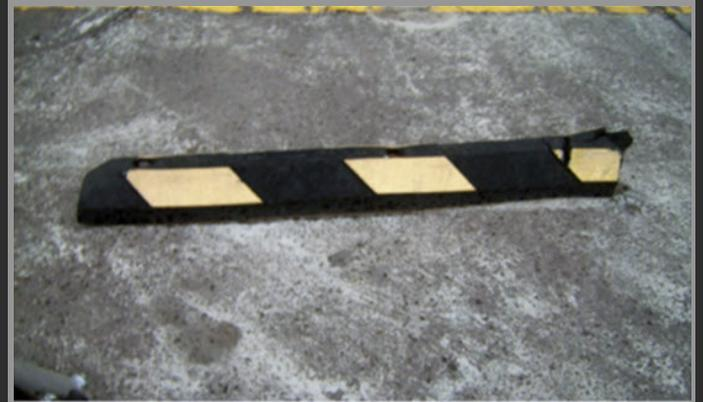
✗ Topes fabricados de 100% hule migajón aglutinado con resina de poliuretano y con el tiempo se desbaratan y deforman
